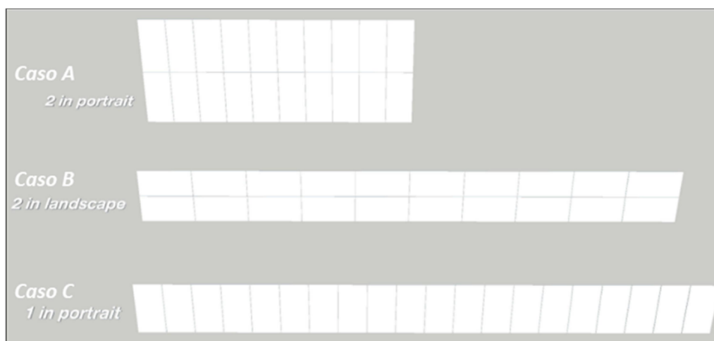
Figura 16: Differenti configurazioni degli inseguitori solari monoassiali.
