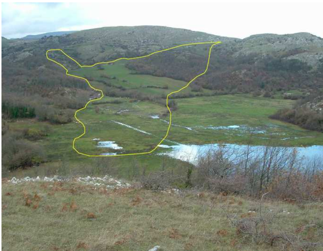
Figura 10 – Aspetto del versante e della piana del bacino. La foto è stata scattata in novembre 2010, durante gli eventi alluvionali che poi hanno portato (in dicembre) al riempimento del bacino (in basso a destra si nota la fase iniziale di accumulo del bacino). La linea gialla indica sommariamente il perimetro delle aree a rischio idrogeologico secondo quanto censito dal Piano di Bacino.
