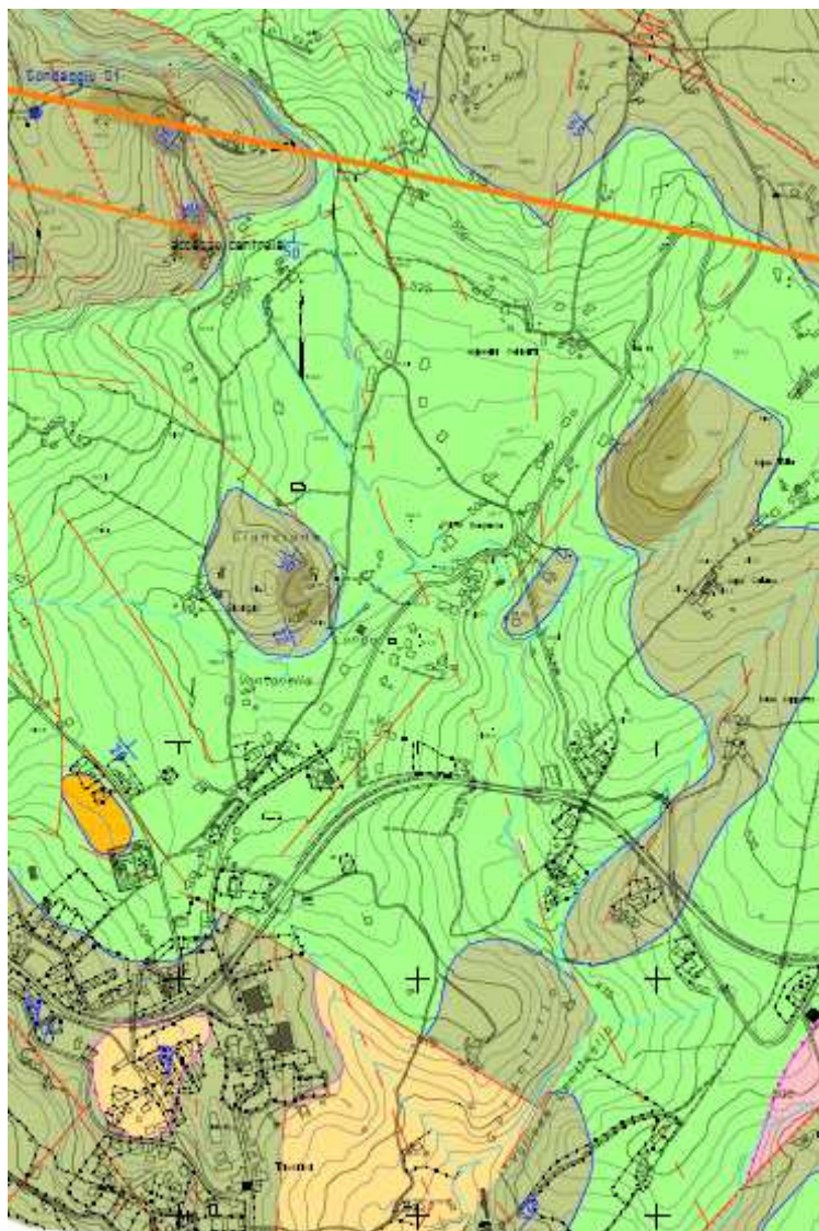
Figura 17 – Estratto carta geologica di progetto; il verde chiaro si riferisce alla facies marnoso-argillitica del Flysch Rosso, il verde scuro alla facies prevalentemente calcarea dello stesso, in giallo marcato il Flysch Numidico, in giallo chiaro e rosa i flysch silicoclastici più recenti. Le linee rosse rappresentano le strutture tettoniche (faglie, lineamenti, ecc...).
