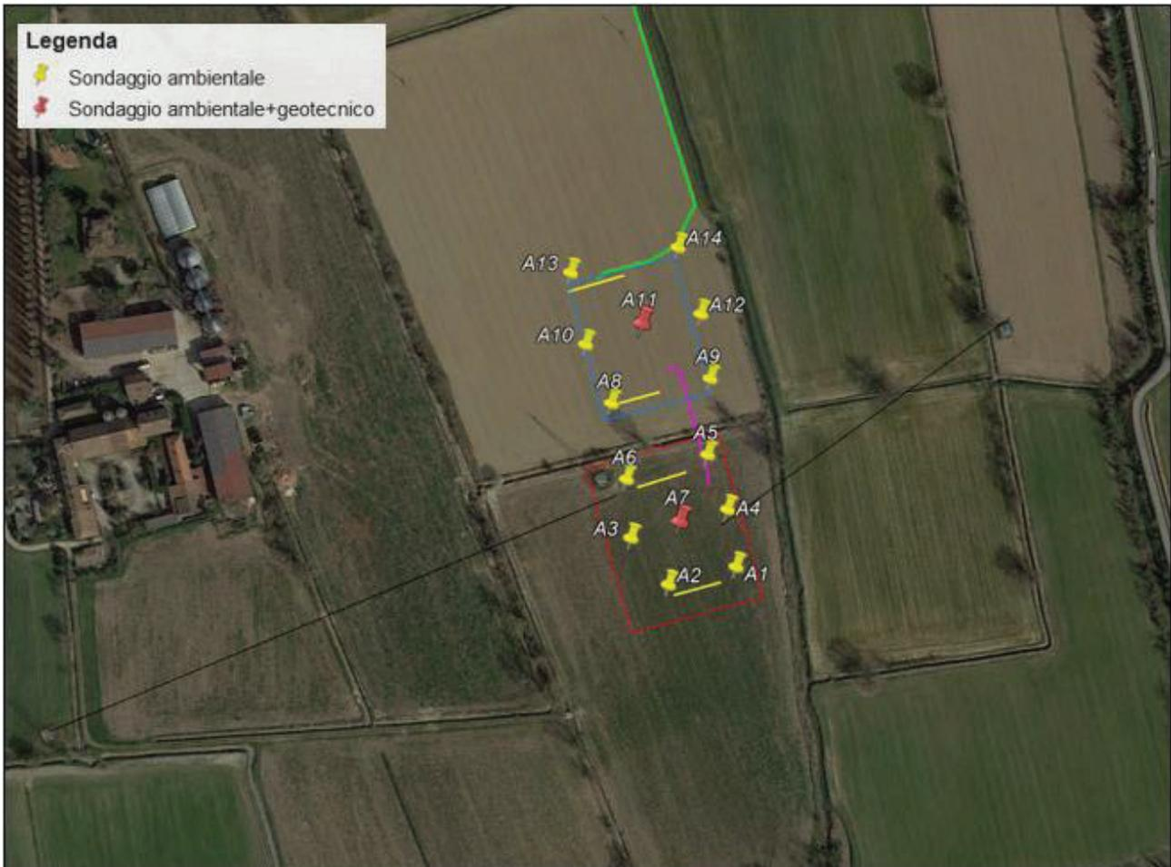
Figura 4-2- Ubicazione indagini nell'area della Stazione elettrica Terna e della Sottostazione Utente.
