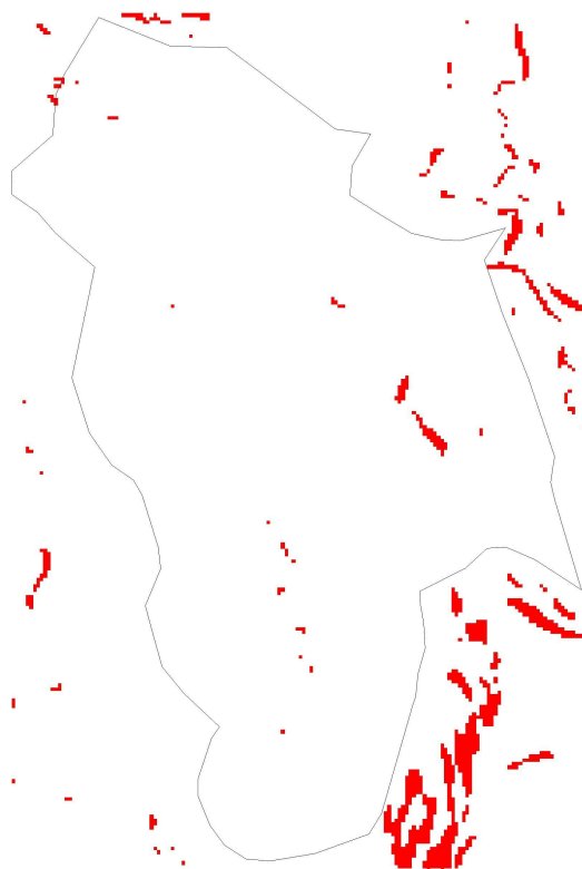
Figura 19 – In rosso, estensione delle aree che in misura potenziale possono essere soggette a crollo in occasione del sisma di riferimento; la linea nera indica i limiti di indagine.
