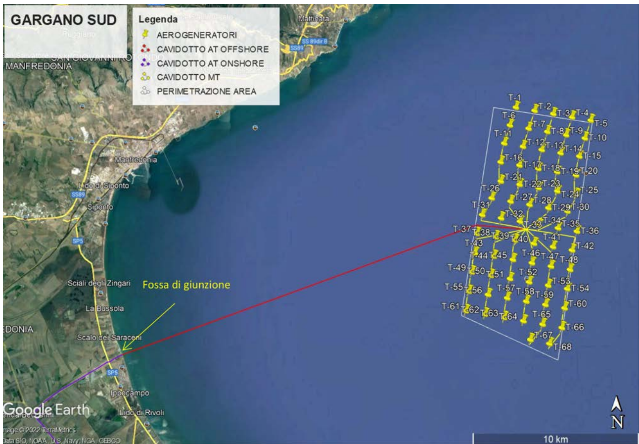
Cavidotto AT Offshore
