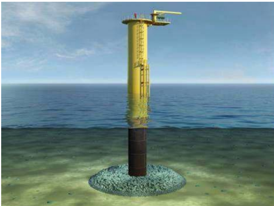
Esempio di fondazione monopalo per aerogeneratore offshore.
