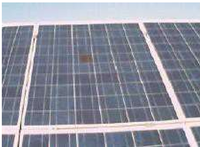
Figura 7: Pannello con Hot - Spot
