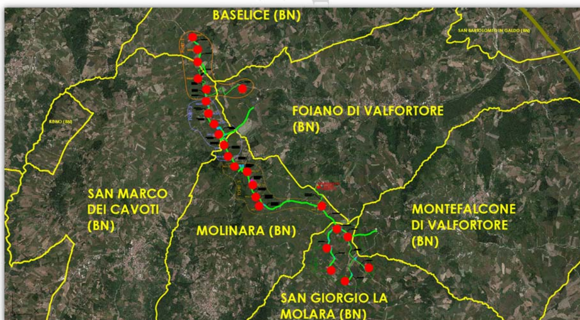
Fig. 6. Inquadramento su ortofoto del parco, situato tra i comuni di Baselice, San Marco dei Cavoti, Foiano di Valfortore, Molinara, San Giorgio la Molar; in rosso, gli aerogeneratori; in verde le tratte di elettrodotti MT.
