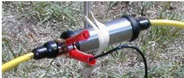
**Figura 3 – Particolare “Smart Electrode”**
