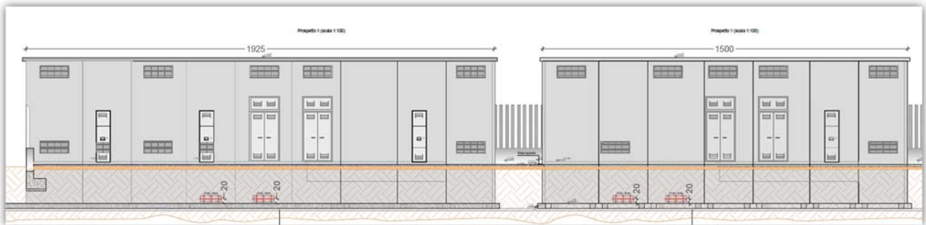
Fig. 18. Prospetto dell'assieme dei nuovi edifici tecnici.
