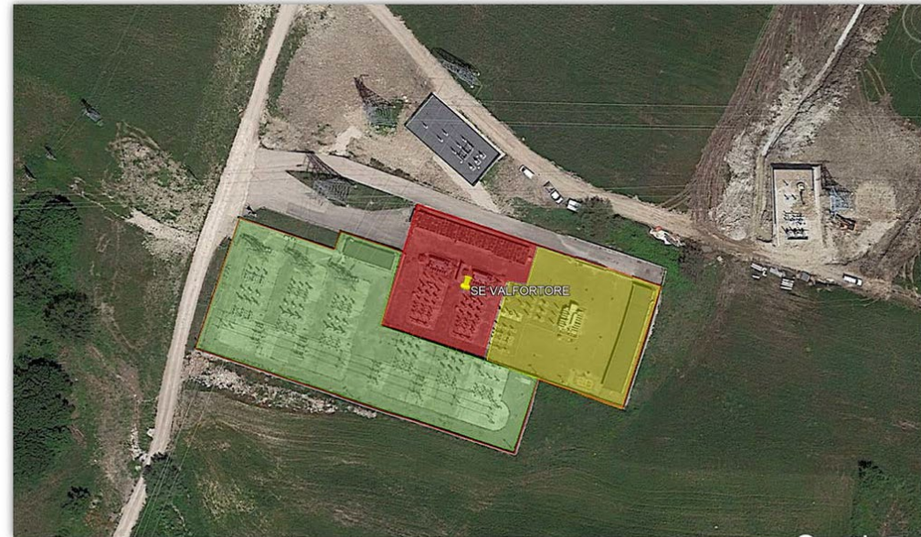
Inquadramento su ortofoto del punto di connessione: in rosso la SSE esistente con i due stalli AT oggetto di adeguamento di potenza e di tensione sul lato MT, che passa da 20 a 30kV. Anche i locali tecnici saranno rinnovati. In verde l'area TERNA; in giallo la SSE di altro produttore.
