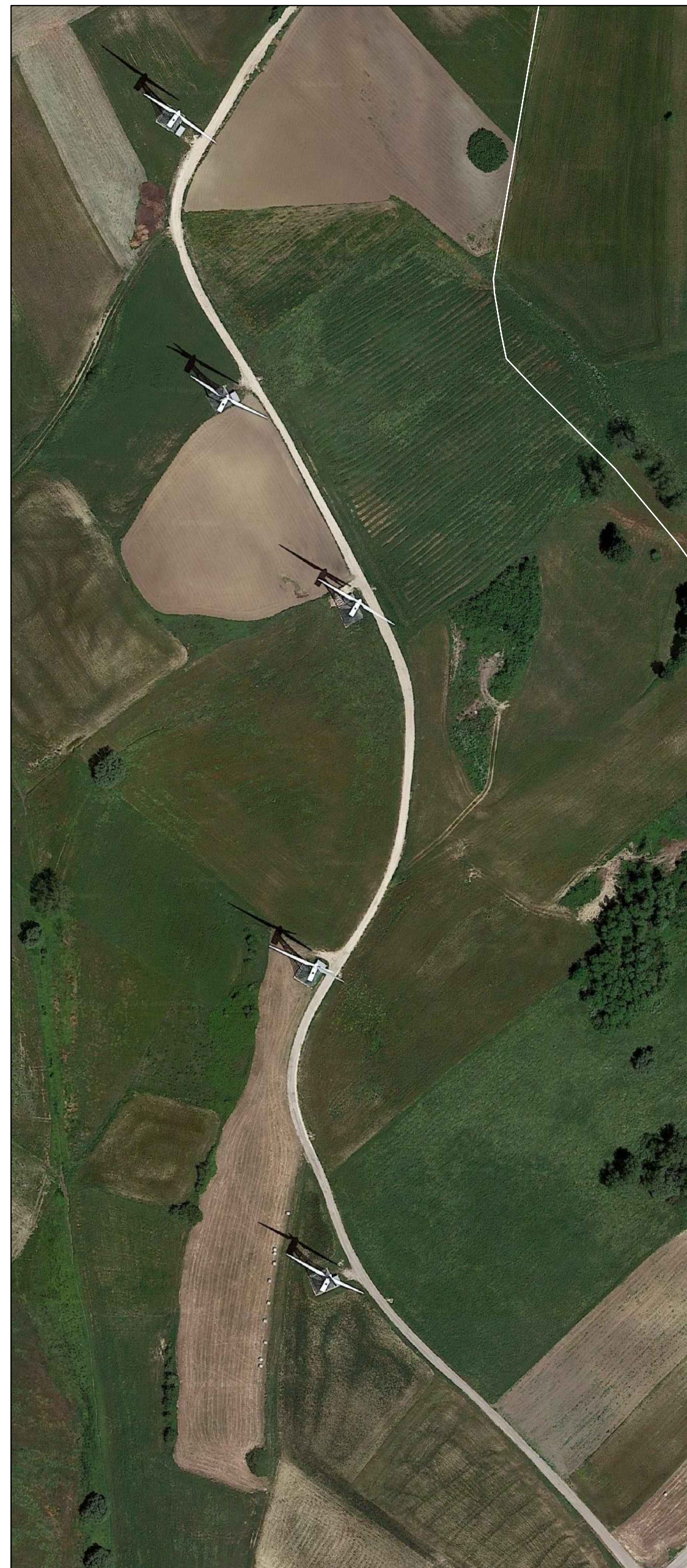
Ante Operam - Stato dei luoghi, aerogeneratori esistenti che saranno smessi.
