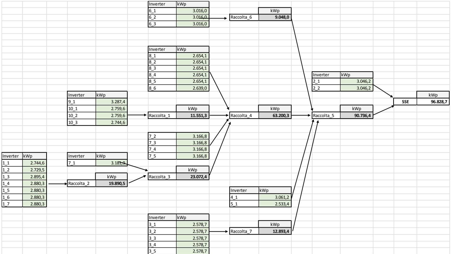
Come evincesi dagli elaborati grafici di dettaglio, relativamente all'impianto di produzione, sono state progettate le opere di distribuzione in M.T. e vettoriamento dell'energia verso la SSEU. Tutti i collegamenti saranno realizzati mediante elettrodotto interrato con tensione di esercizio 30 kV, in cavo tipo ARE4H5(AR)E 18/30 kV – alluminio.
