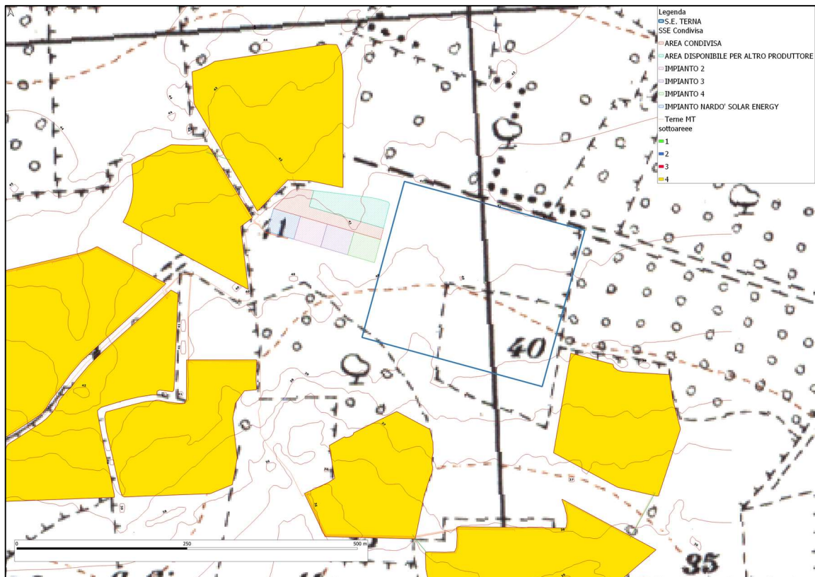
Figura: Curve di livello ad 1 m dell'area della particella catastale del foglio 41 p.lla 6 del Comune di Nardò, sede dell'ubicazione della nuova stazione di elevazione e della Stazione elettrica Terna di Nuova realizzazione.
