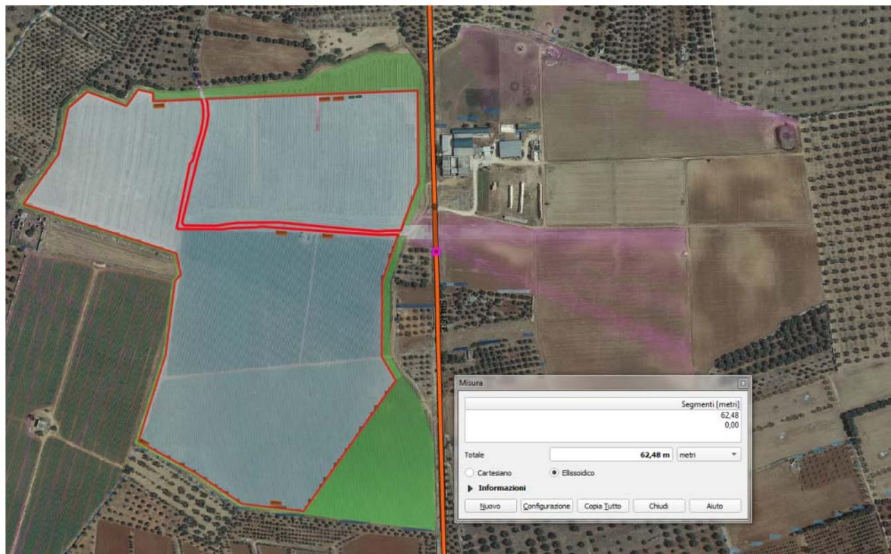
Fig. 2.6: Analisi di visibilità potenziale dell' IMPIANTO IN PROGETTO (FV in rosso, quinta di mitigazione in verde) su ortofoto: è stata considerata l'orografia, l'uso del suolo(SIT PUGLIA 2011) e la quinta di mitigazione visiva
