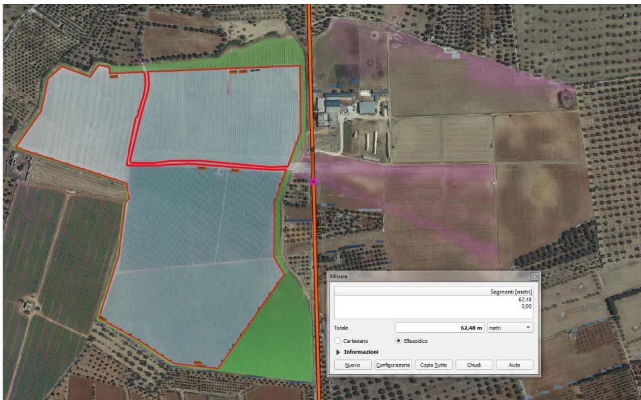
Fig. 2.4: Analisi di visibilità potenziale dell' IMPIANTO IN PROGETTO (FV in rosso, quinta di mitigazione in verde) su ortofoto: è stata considerata l'orografia, l'uso del suolo (SIT PUGLIA 2011) e la quinta di mitigazione visiva
