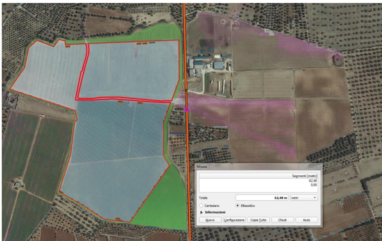
Fig. 7.6: Analisi di visibilità potenziale dell' IMPIANTO IN PROGETTO (FV in rosso, quinta di mitigazione in verde) su ortofoto: è stata considerata l'orografia, l'uso del suolo(SIT PUGLIA 2011) e la quinta di mitigazione visiva
