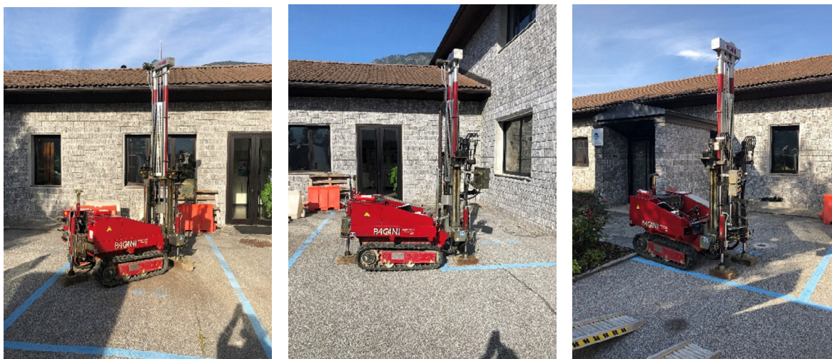
Figg. 10. Le riprese evidenziano il tipo di attrezzatura utilizzata per l'esecuzione delle prove SCPT (tipo DPSH, Meardi-Agi) con strumento Pagni mod. TG 63-100). Nel dettaglio, la strumentazione è posizionata, da sinistra verso destra, rispettivamente, nelle postazioni di sondaggio P1, P2 e P3.
