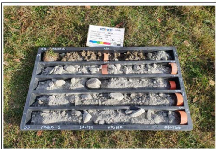
Figura 22: stratigrafia sondaggio S3 ambientale campagna 2020
