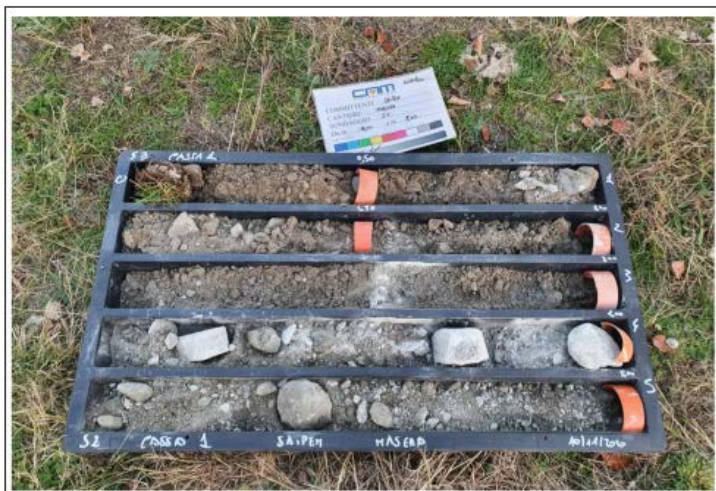
Figura 21: stratigrafia sondaggio S2 ambientale campagna 2020
