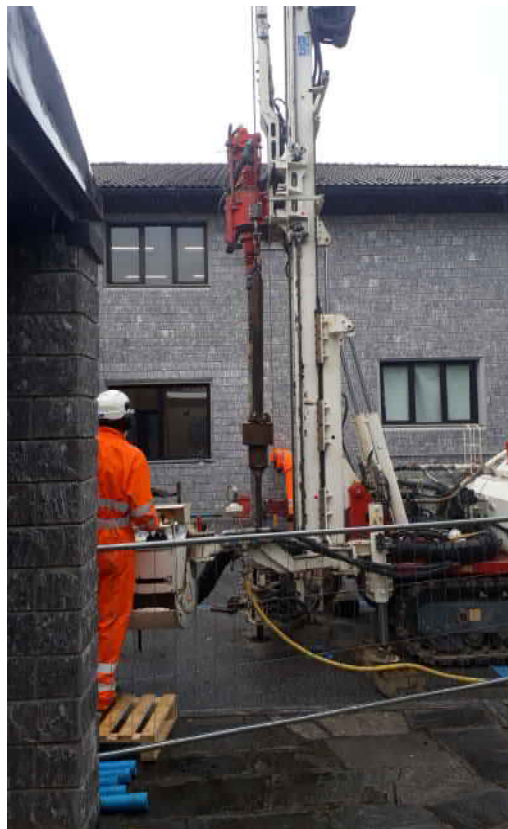
Esecuzione di una prova SPT
