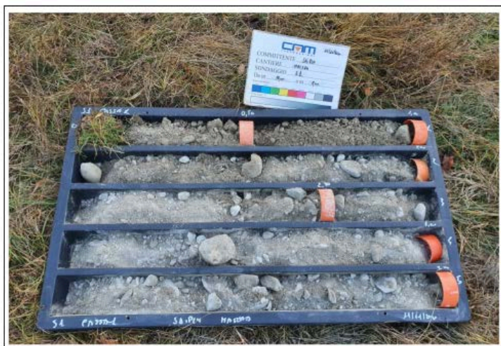
Figura 20: stratigrafia sondaggio S1 ambientale campagna 2020
