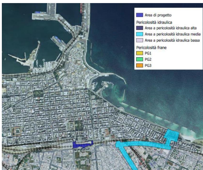
Figura 12: Localizzazione dell’intervento in relazione alle aree di pericolosità idraulica (Stralcio del Piano per l’Assetto Idrogeologico) (Fonte: Lista di controllo)
