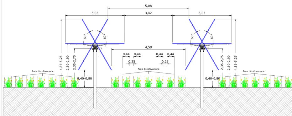
STRUTTURA DI SOSTEGNO E SPAZI DI PIANTUMAZIONE
