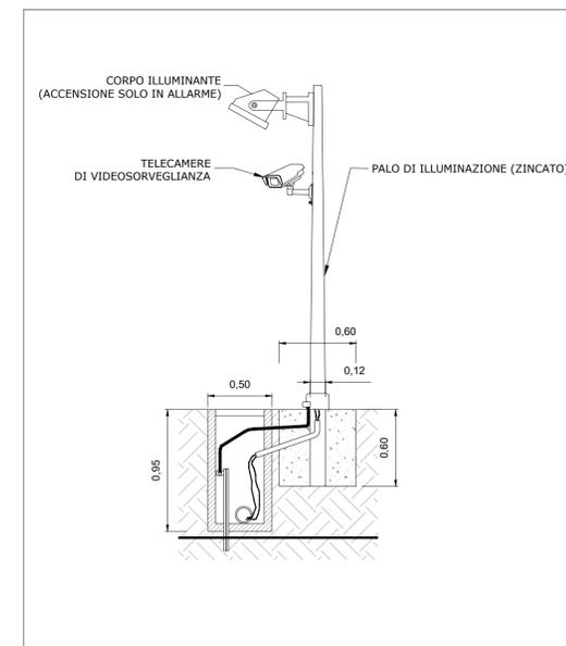
**STRUTTURA DI SOSTEGNO E FASCIA DI RISPETTO DAI CONFINI**
