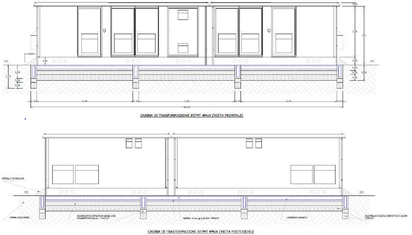
Fig. 7 - Cabina di trasformazione BT/MT (4000 kVA)
