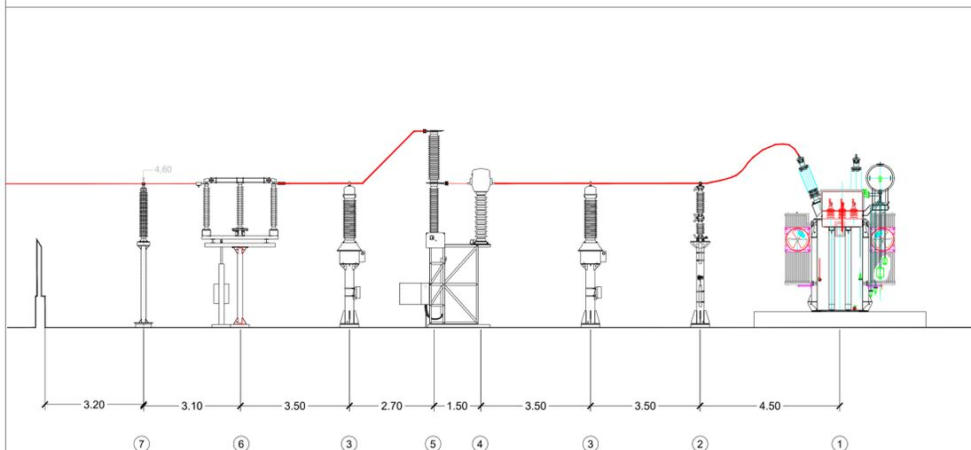
PIANTA E SEZIONE BB' - TRASFORMATORE
