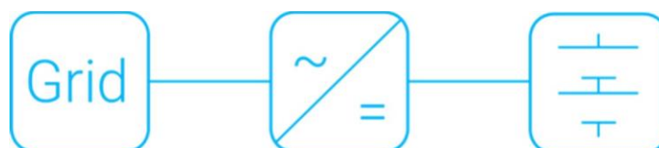
Schema semplificato di un convertitore monostadio
