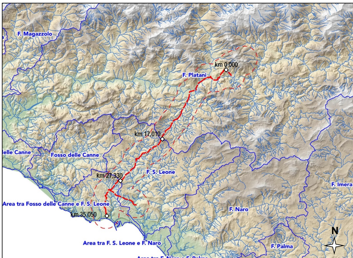
Fig. 4.1/A - Bacini idrografici attraversati dal metanodotto
