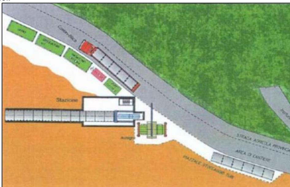
**Fig. 2.3.2/C** - Schema tipo di un cantiere per l'installazione di un microtunnel
