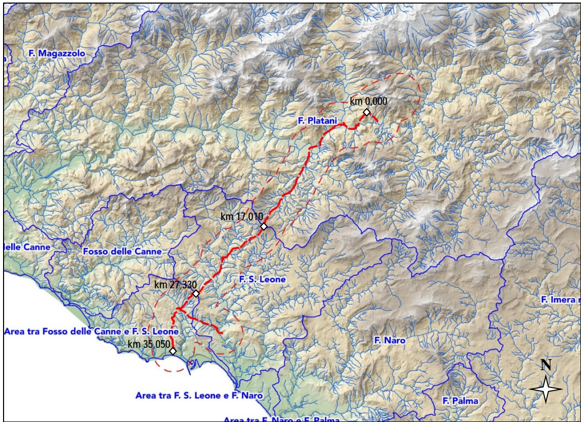
Fig. 4.1: Bacini idrografici attraversati dal metanodotto
