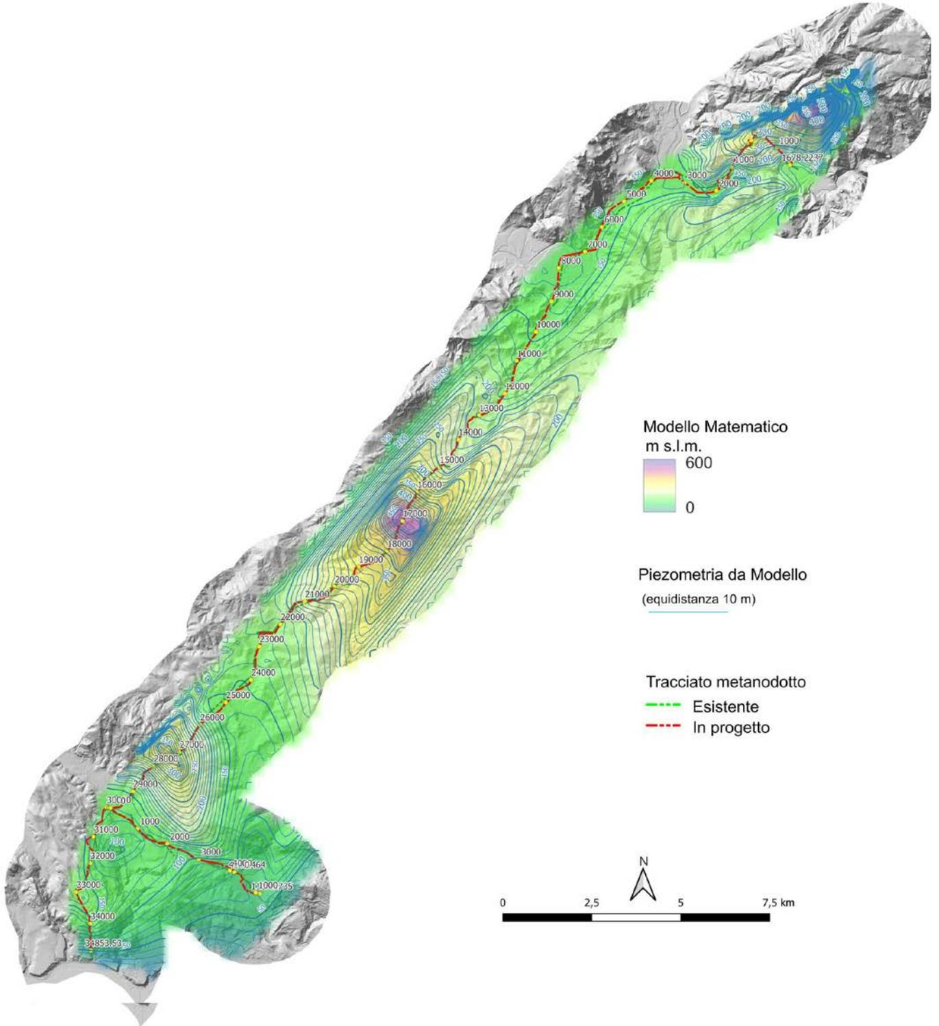
**Figura 1.1/B: Modello idrogeologico di flusso.**
