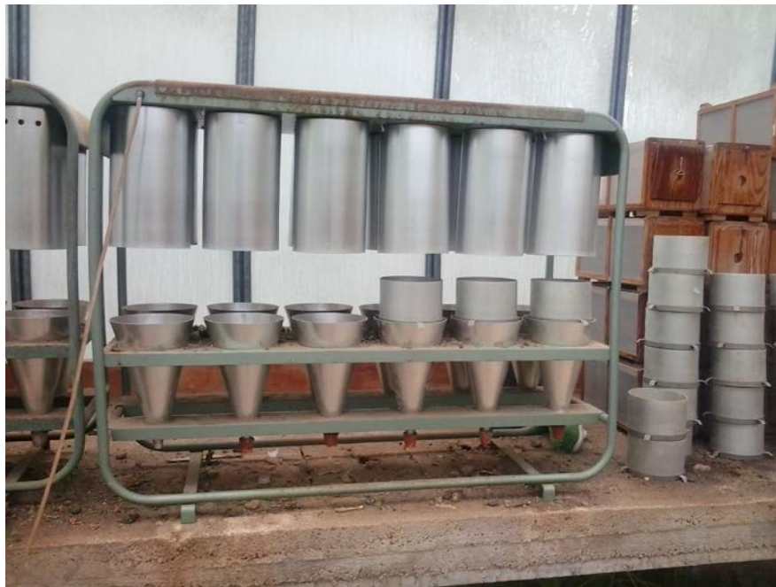
Foto 4.1 - Estrattore dinamico del tipo Berlese-Tullgren
