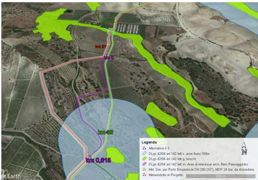
**Fig. 3.2/C - Ortofoto con indicazione delle Alternative del Tratto 3 dal km 31,080 al km 31,820 - Comune di Porto Empedocle. In verde la linea esistente da dismettere, in viola l'“Alternativa n. 3” e in rosso l'alternativa “Metanodotto in progetto”**
