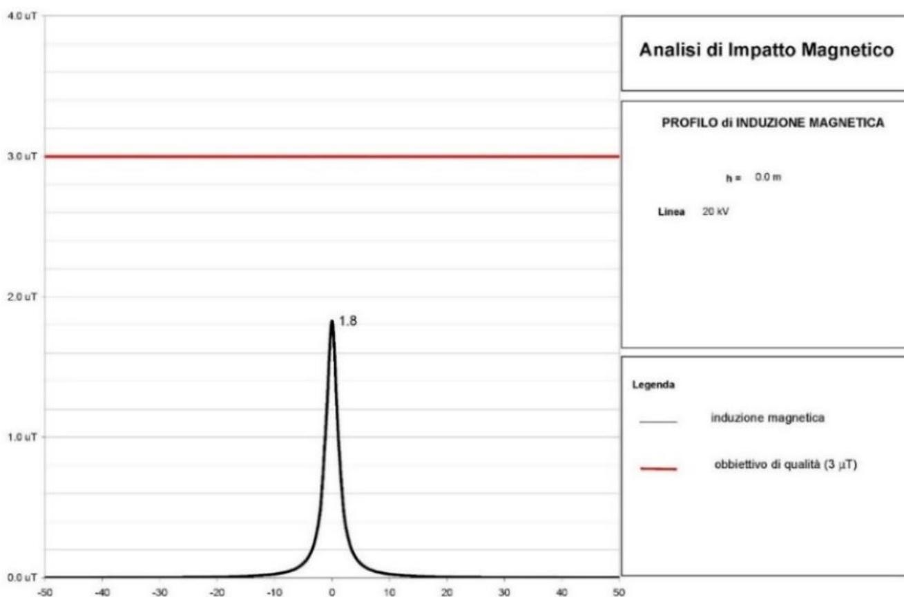
FIGURA 2 – RAPPRESENTAZIONE DEL LIVELLO DI CAMPO MAGNETICO MASSIMO DEL CAVIDOTTO
