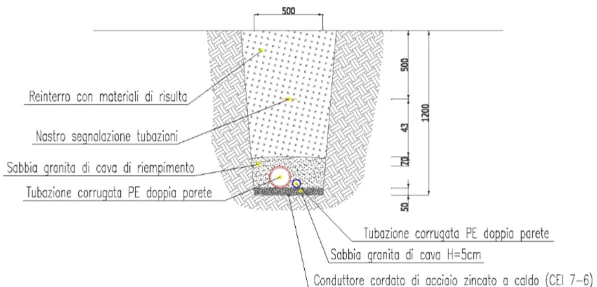
*Cavidotto interno BT – Sezione tipologica di scavo*
