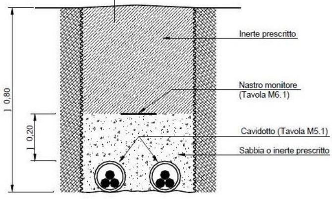
SEZIONI TIPICHE DI POSA DEL CAVIDOTTO INTERNO AL PARCO E DEL CAVIDOTTO ESTERNO AL PARCO
