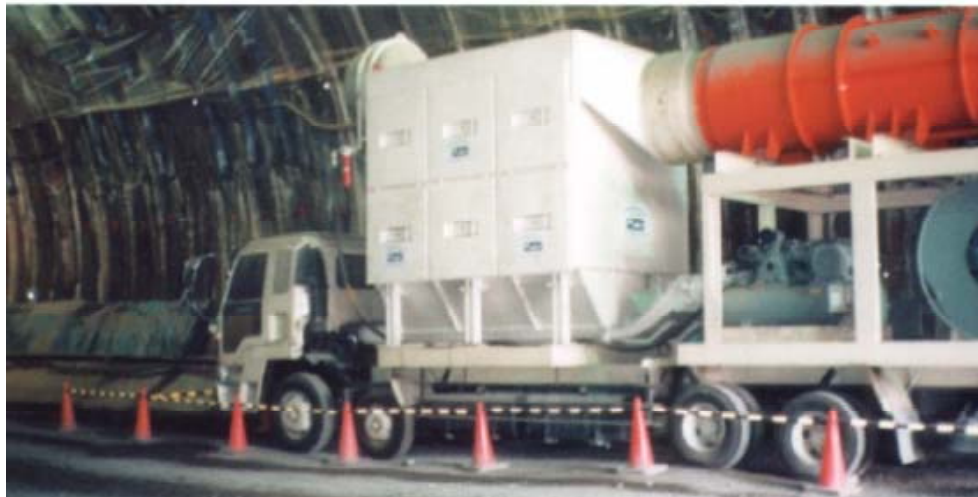
Figura 6.1: Esempi di Depolveratori in Cantiere (CFT Dry Deduster, www.cft-qmbh.de )
