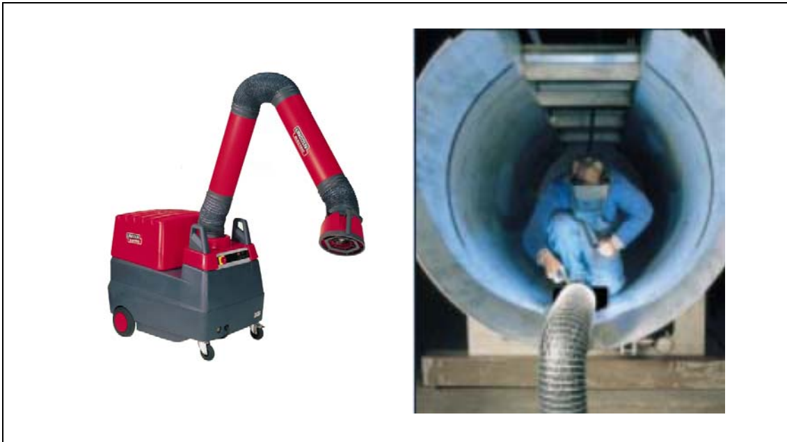
Figura 2.5: Aspiratori e Depuratori Mobili per Fumi di Saldatura
