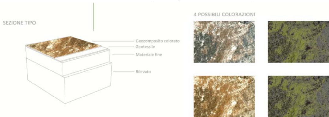
Figura 4.c: Sezione Tipologica Finitura Fondo Bacino
