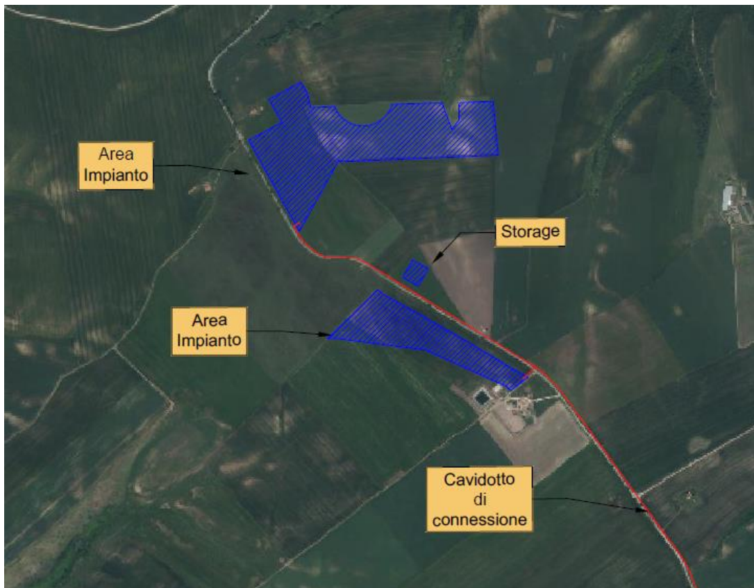
Figura 29: Planimetria su ortofoto con indicazione del sistema di accumulo
