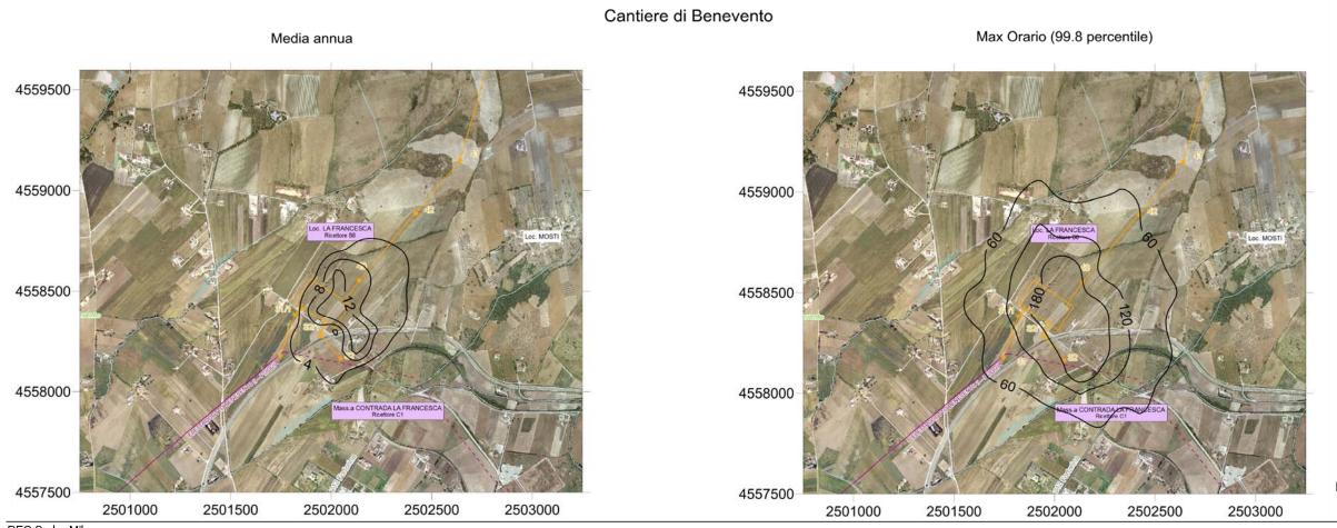
FASE DI CANTIERE, ANALISI DI DISPERSIONE DI INQUINANTI, MAPPA DELLE CONCENTRAZIONI DI NOx IN ATMOSFERA A LIVELLO DEL SUOLO
