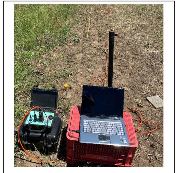
L'elaborazione del sismogramma ha consentito di estrapolare lo spettro di velocità (fig. a) dal quale si è risalito tramite picking alla curva di dispersione che consente di ottenere sia gli spessori dei vari strati che le rispettive velocità.
