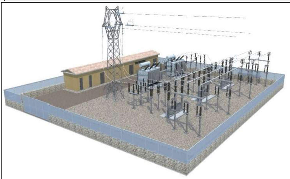
Figura 5-9 Sottostazione tipo con apparecchiatura ad alta tensione, trasformatore, quadri di media tensione e armadio di comando
