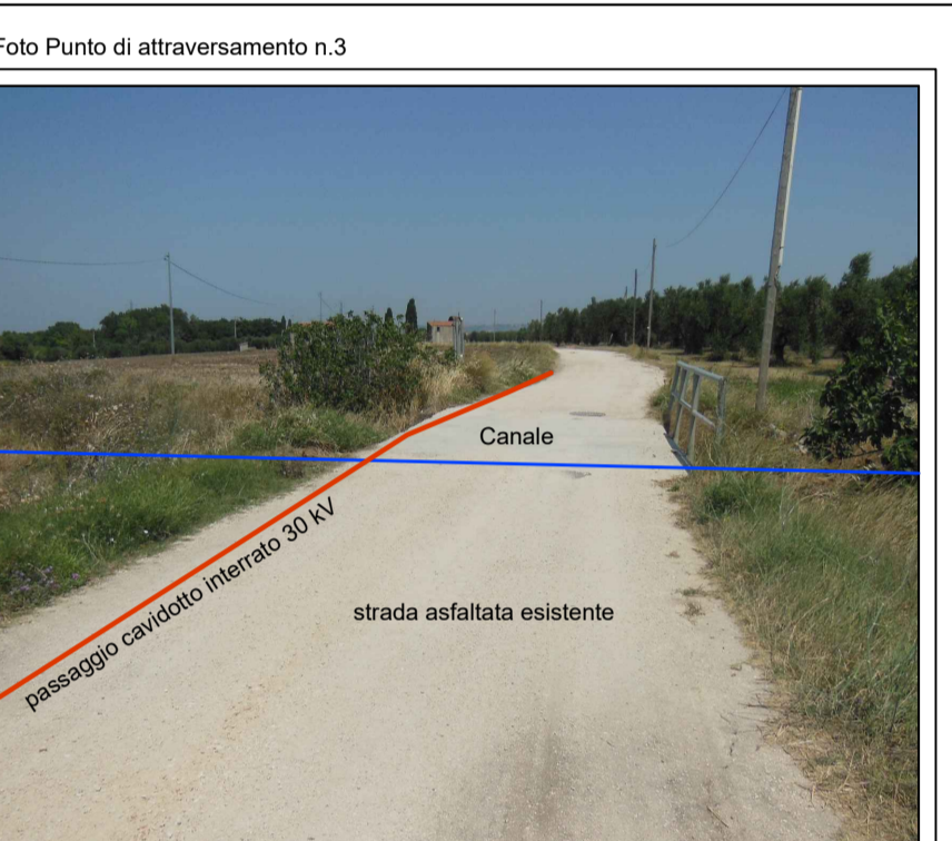
Foto Punto di attraversamento n.3 Attraversamento Canale su ponte esistente Coordinate: Lat. 41.747691° Long. 15.061952°
