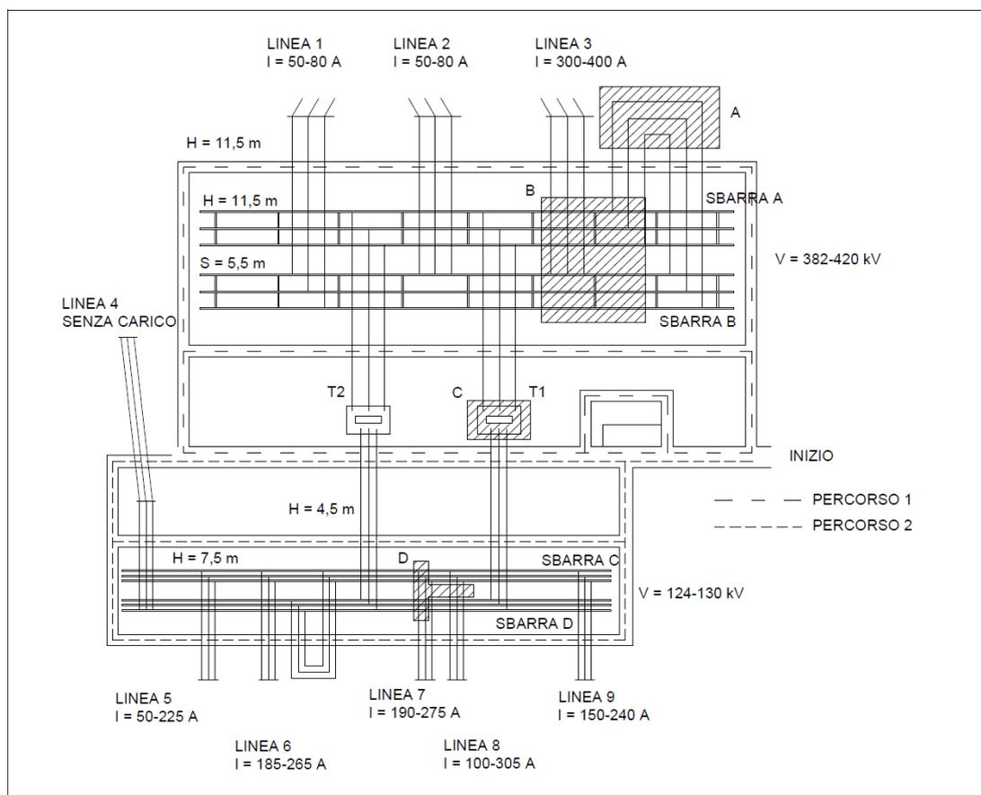
**Figura 1** – Pianta di una tipica stazione 380/132 kV con l'indicazione delle principali distanze fase-fase (S) e fase-terra (H) e delle variazioni delle tensioni e delle correnti durante la fasi di misurazioni di campo elettrico e magnetico.
