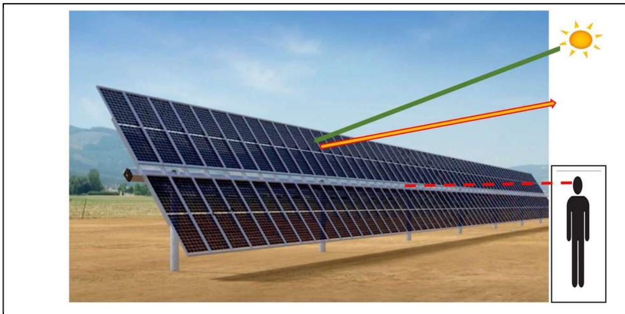
Figura 21-2 Riflessione dei raggi solari sui moduli fotovoltaici montati su tracker
