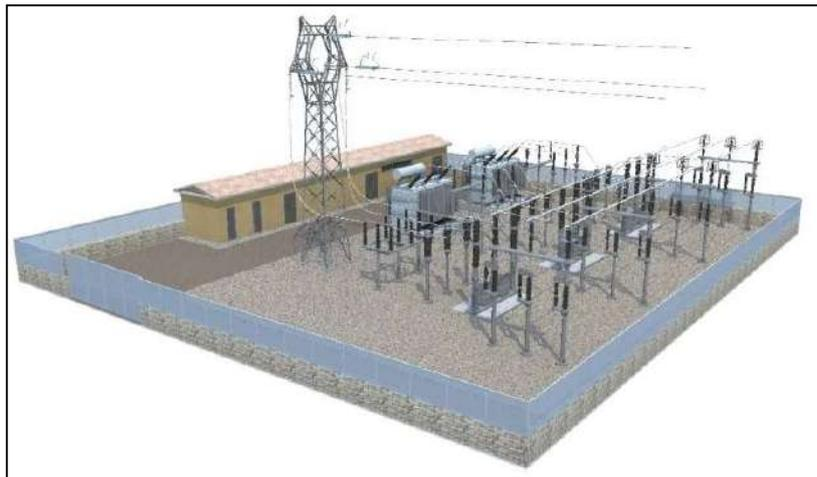
*Figura 12-9 Sottostazione tipo con apparecchiatura ad alta tensione, trasformatore, quadri di media tensione e armadio di comando.*
