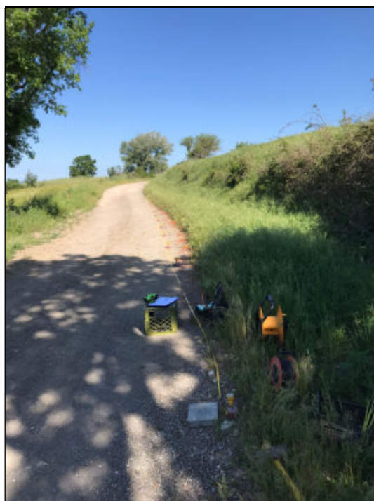
Foto 6: Esecuzione della stesa geofisica MASW1 nei pressi dei siti WTG ON07 e ON10.
