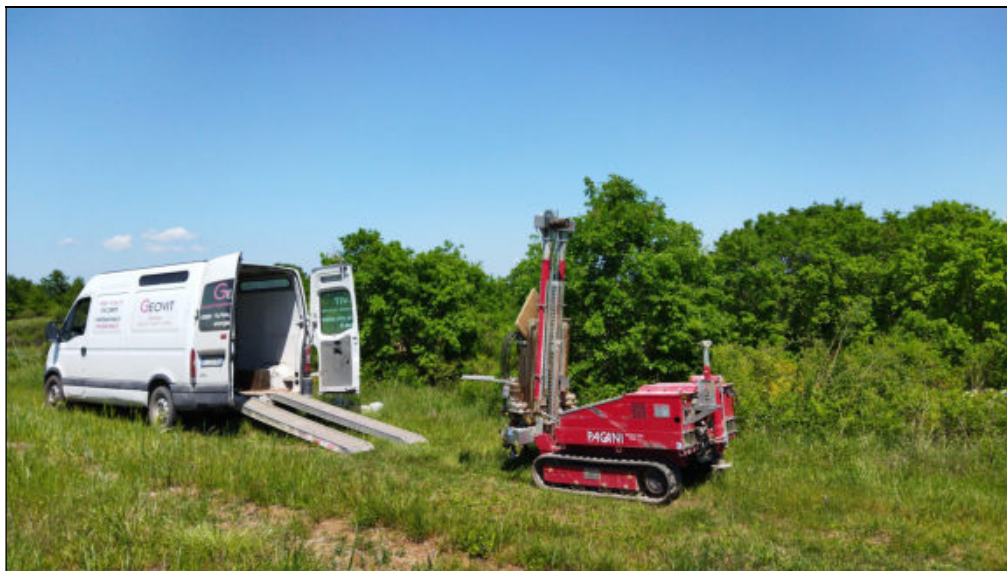
Foto 5: Esecuzione prova penetrometrica DPSH5 sul sito WTG 0N09.
