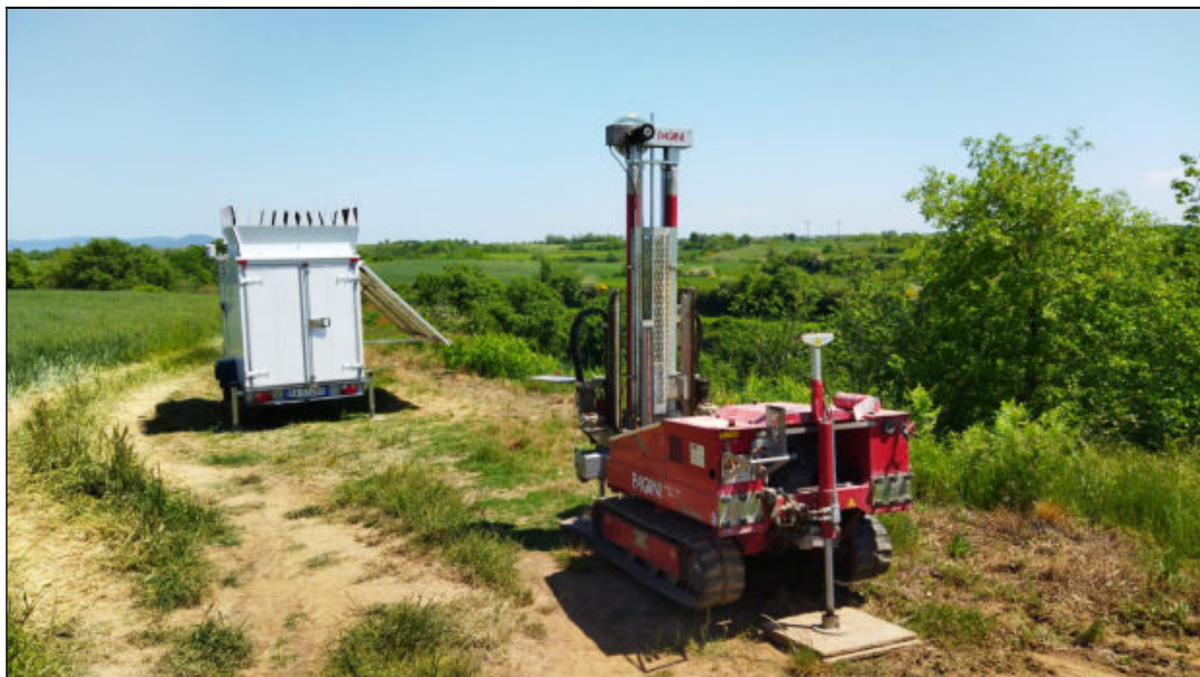
Foto 3: Esecuzione prova penetrometrica DPSH3 sul sito WTG ON02.
