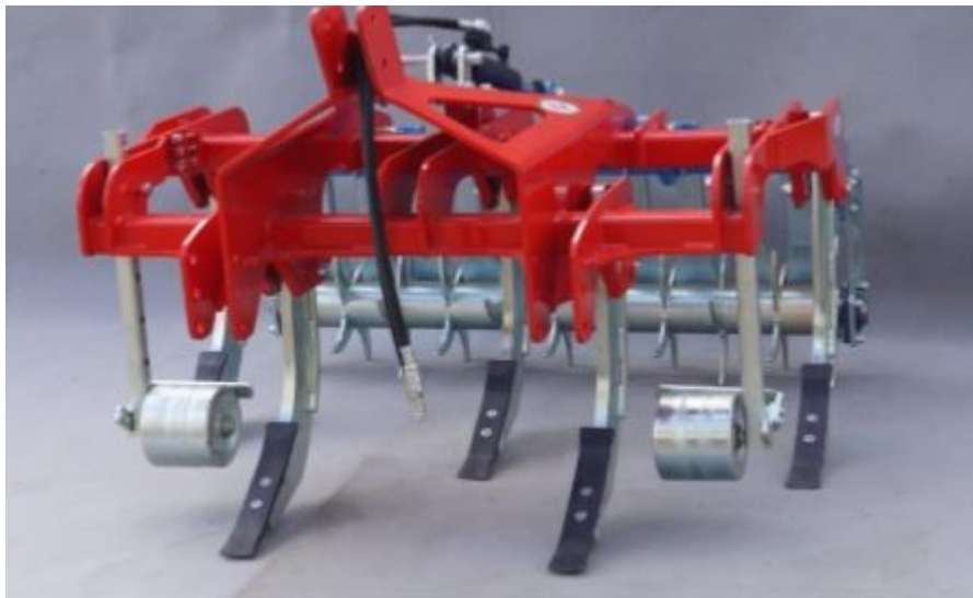
Foto n.10. Ripper tipo da impiegarsi per la ripperatura nelle lavorazioni preparatorie del mirteto
