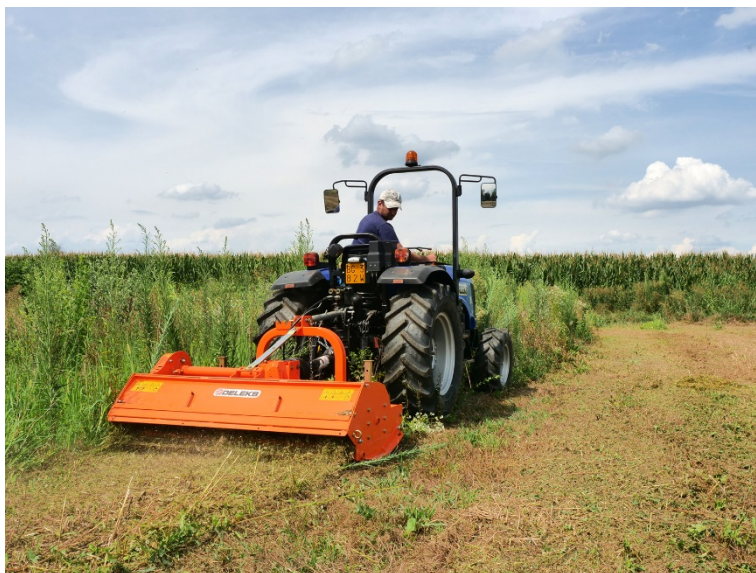
Foto n.15. Trinciatrice tipo da accoppiarsi alla trattrice e da utilizzarsi per la trinciatura meccanica delle erbe infestanti presenti negli interfilari
