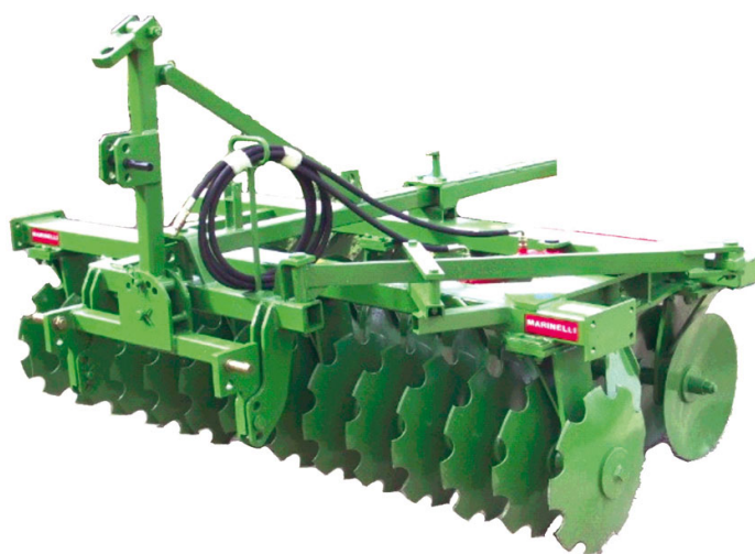
Foto n.12. Frangizolle tipo da utilizzarsi per la frangizollatura per le lavorazioni preparatorie del mirto
