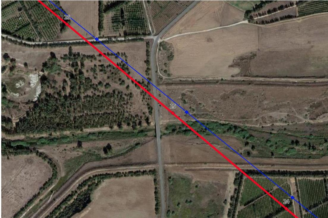
Figura 6 – Inquadramento della linea nuova (rosso) e di quella esistente (blu), nella zona di attraversamento del Torrente Leni.
