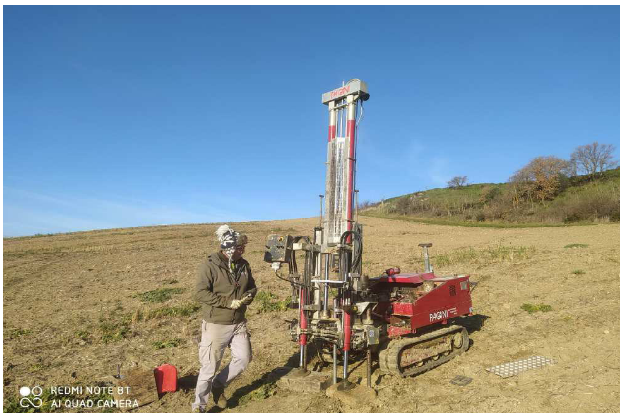
Postazione prova penetrometrica statica CPT5
