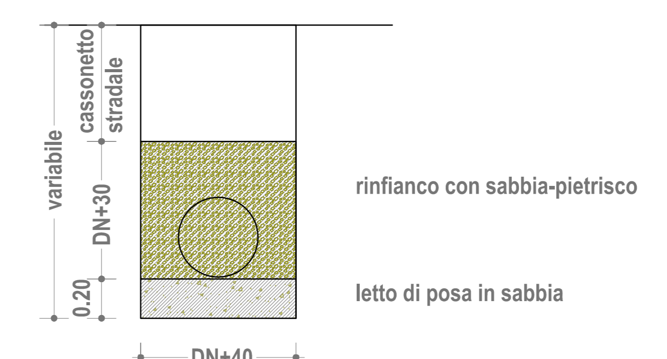
Sezione tipo all'interno della sottostazione scala 1:20
