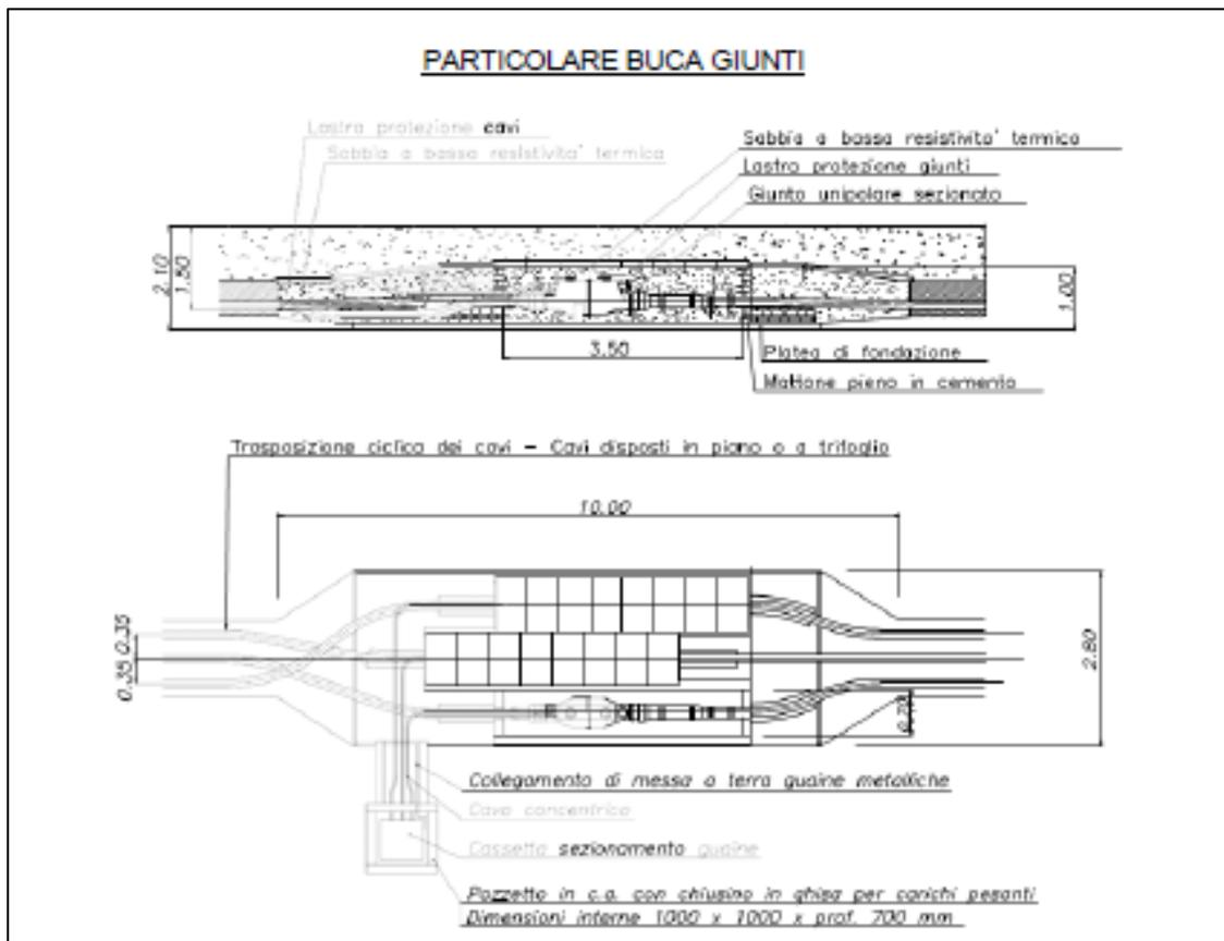
Gli schermi metallici intorno ai conduttori di fase dei cavi con isolamento estruso hanno la funzione principale di fornire una via di circolazione a bassa impedenza alle correnti di guasto in caso di cedimento di isolamento. Pertanto essi saranno dimensionati in modo da sostenere le massime correnti di corto circuito che si possono presentare.
