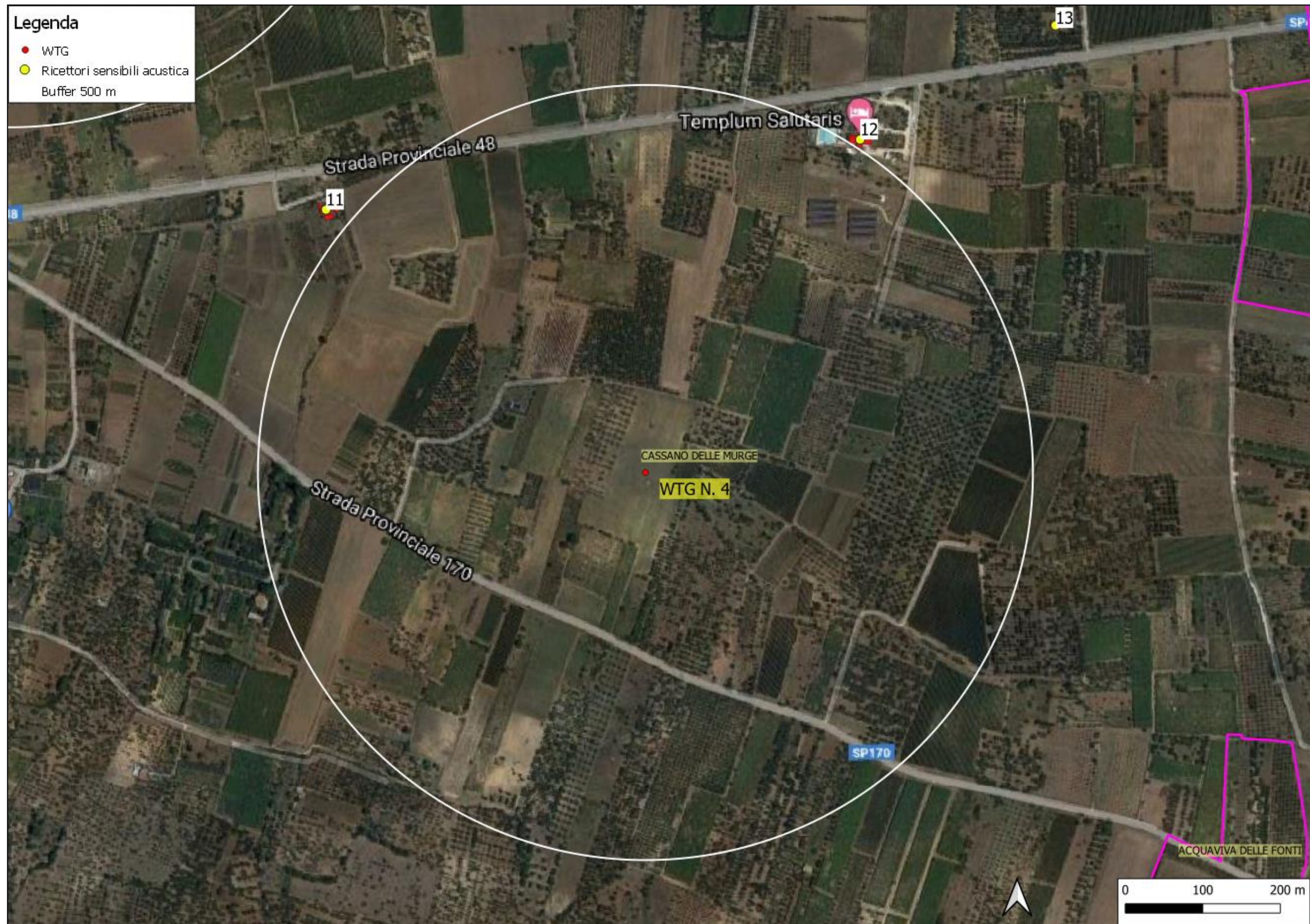
Ricettori nell'area buffer di 500 m – Nelle vicinanze della WTG 4 non si riscontra la presenza di ricettori sensibili
