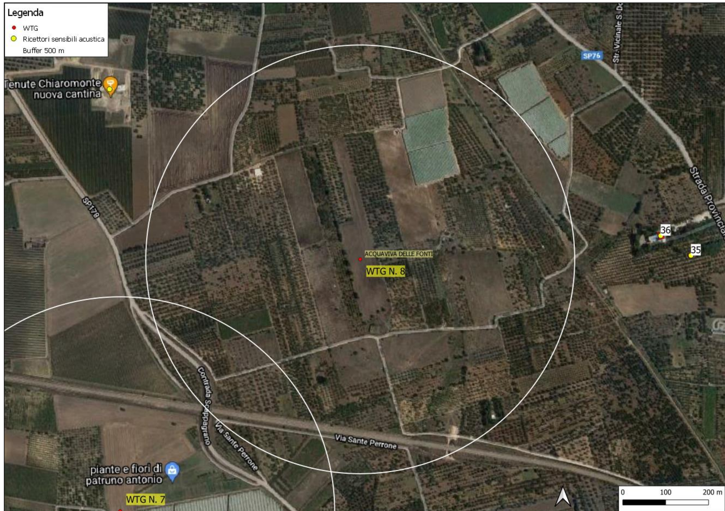
Ricettori nell'area buffer di 500 m – Nelle vicinanze della WTG 8 non si riscontra la presenza di ricettori sensibili
