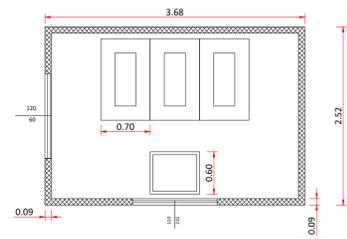
PIANTA CABINA SEZIONAMENTO
