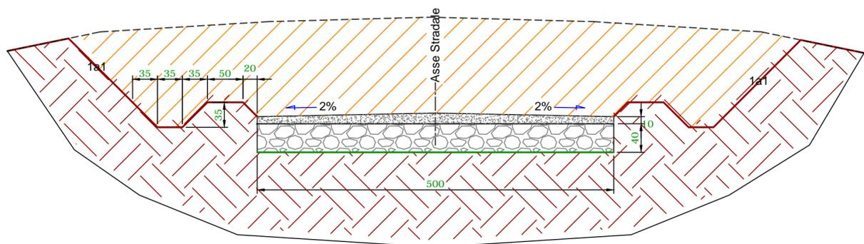
SEZIONE TIPICA GENERICA IN RILEVATO
