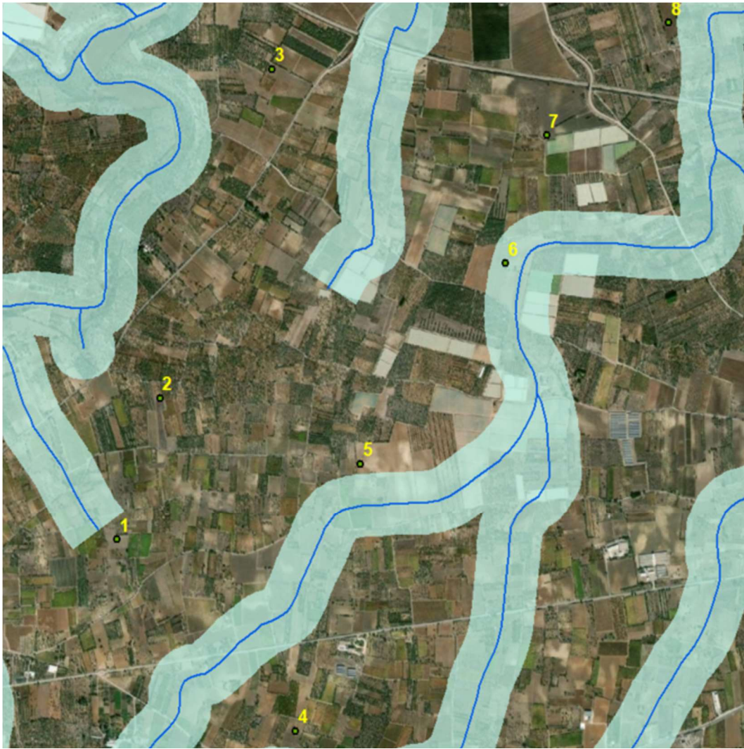
Fig. 2 – Ubicazione aerogeneratori su ortofoto con evidenza del reticolo idrografico e relativo buffer di 150 m.
