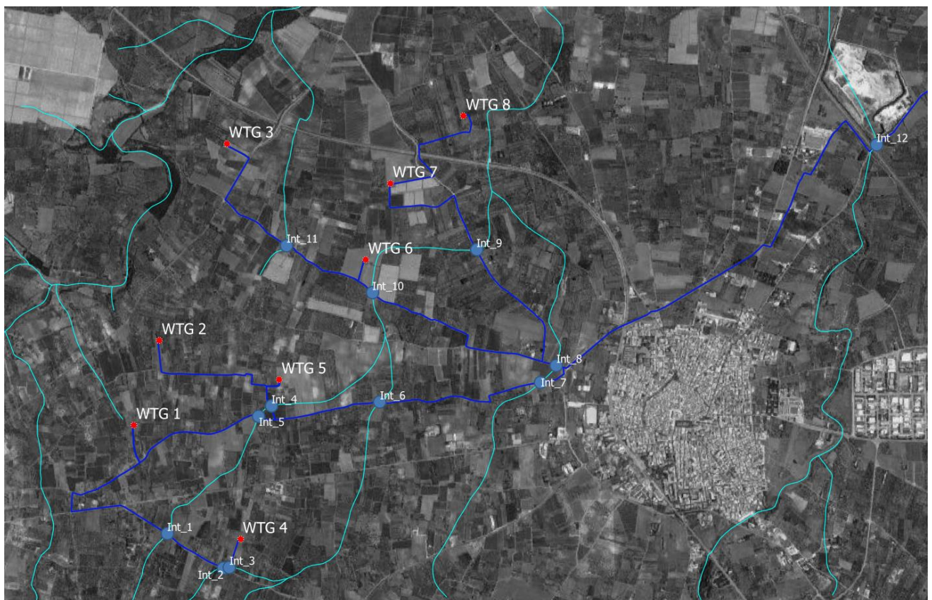
Intersezioni del cavidotto (in blu) con il reticolo idrografico (in ciano) su ortofoto
