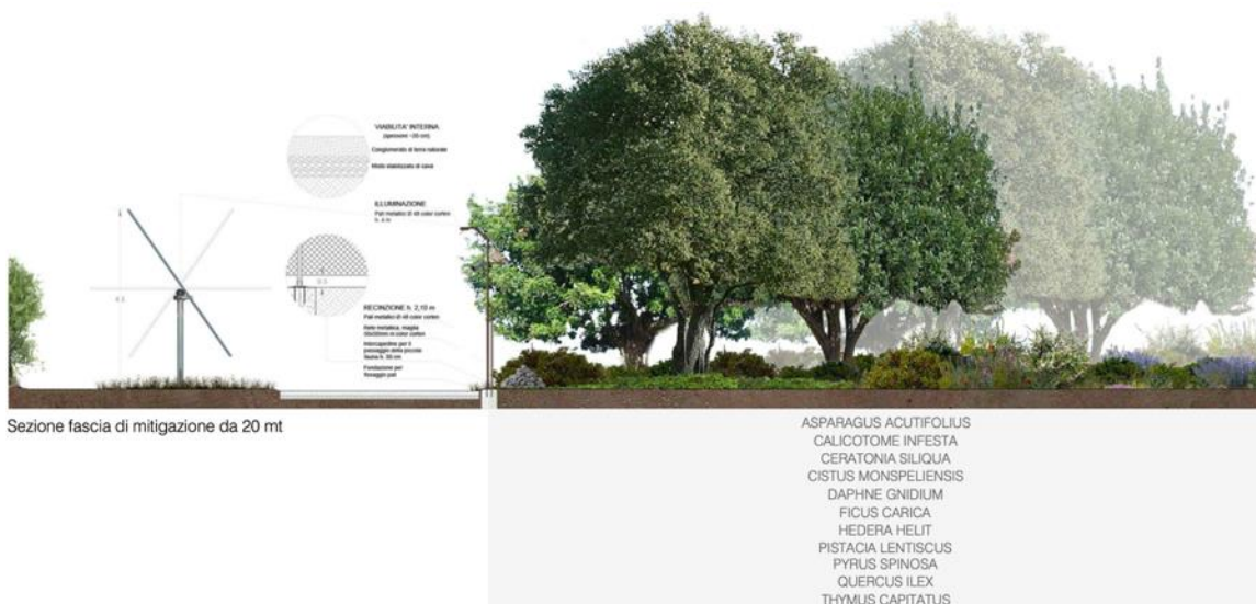
Figura 19 _ Fascia di mitigazione di sezione di 20m e sistema perimetrale all'impianto agrivoltaico
